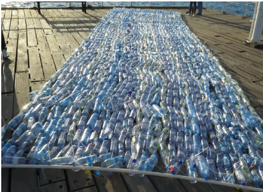
2.4. ábra. A műanyag palackokból elkészített céltárgy.
