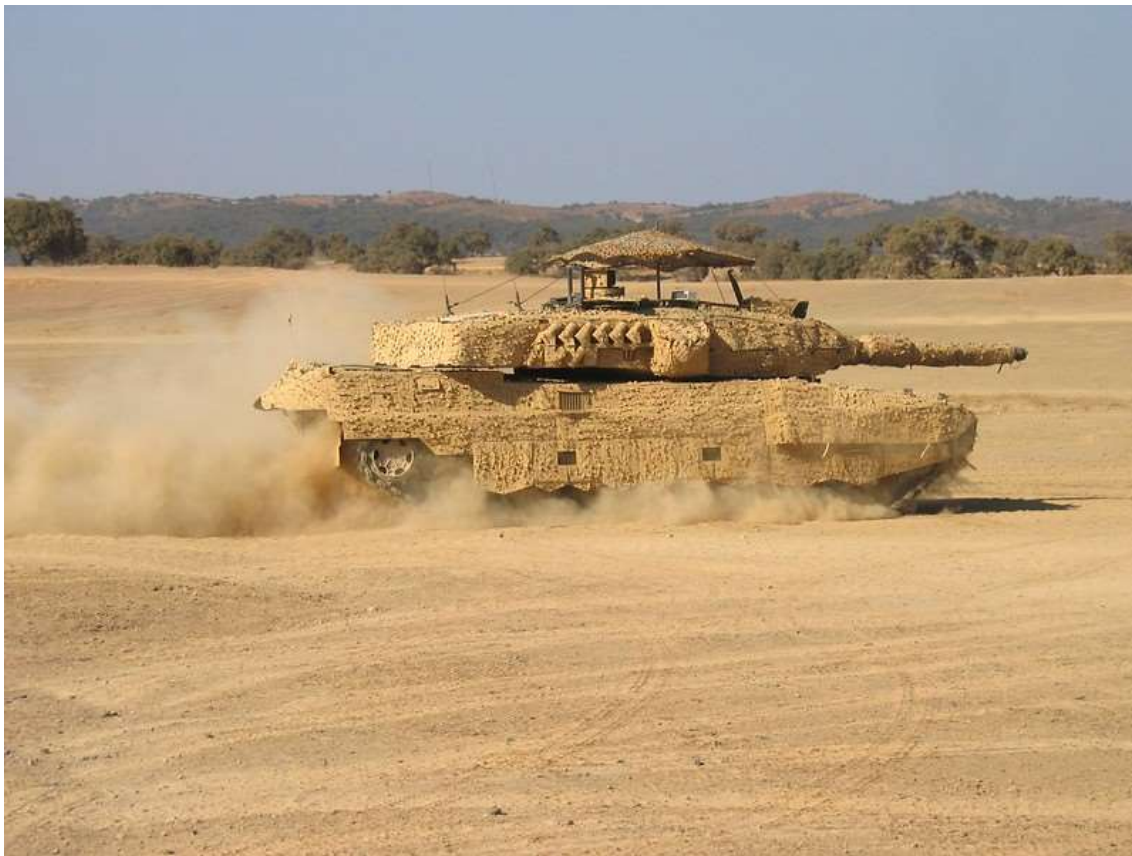
1. sz. melléklet: Multispektrális álcázókészlettel és Hőátadást Csökkentő Rendszerrel felszerelt Leopard 2 típusú harckocsi
