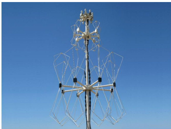
26. ábra Példa különböző frekvenciatartományok megfigyelésére alkalmas pszeudó-doppler antennarendszerek együttes alkalmazására 47
