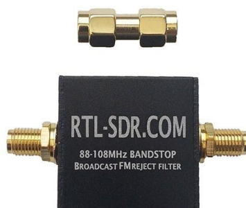
41. ábra SDR eszközhöz csatlakoztatható sávszűrő 67
