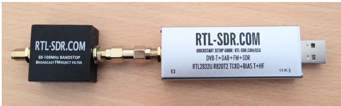
42. ábra Sávszűrővel ellátott SDR eszköz (RTL-SDR Dongle) 68
