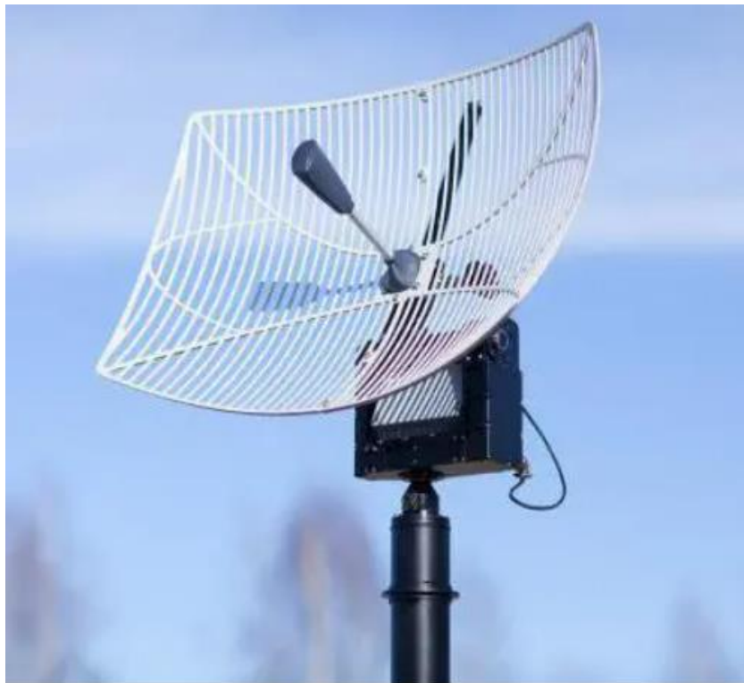
44. ábra Szervomotorok segítségével mozgatható irányított antenna 74
