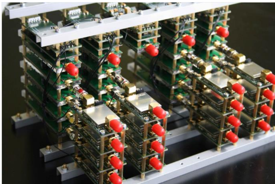
50. ábra Példa nagy csatornaszámú koherens vevőre 80
