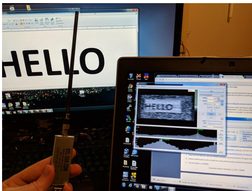
43. ábra Van Ech-phreaking RTL-SDR dongle felhasználásával 73
