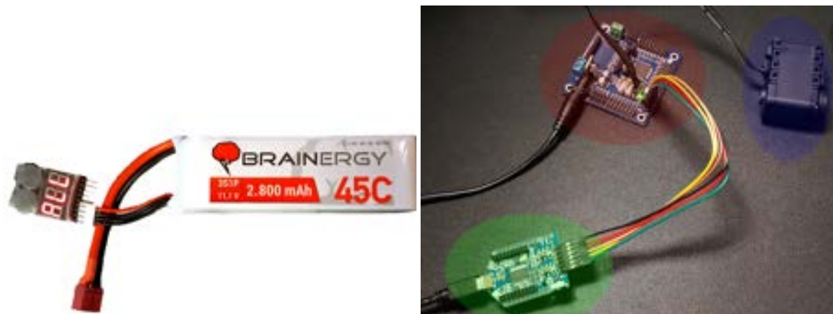
A.1. ábra. Bal: Brainenergy 11.1V 2800mAh 45C LiPo akkumulátor T konnectorral és hozzácsatlakoztatva a feszültség ellenőrző. Jobb: Piros: ArbotiX-M Robocontroller, Zöld: FTDI-USB átalakító, Kék: AX-12A okos szervomotor, az aktuátor áramellátása érdekében a robovezérlő kártya egy külső 12V-os áramforráshoz van csatlakoztatva
