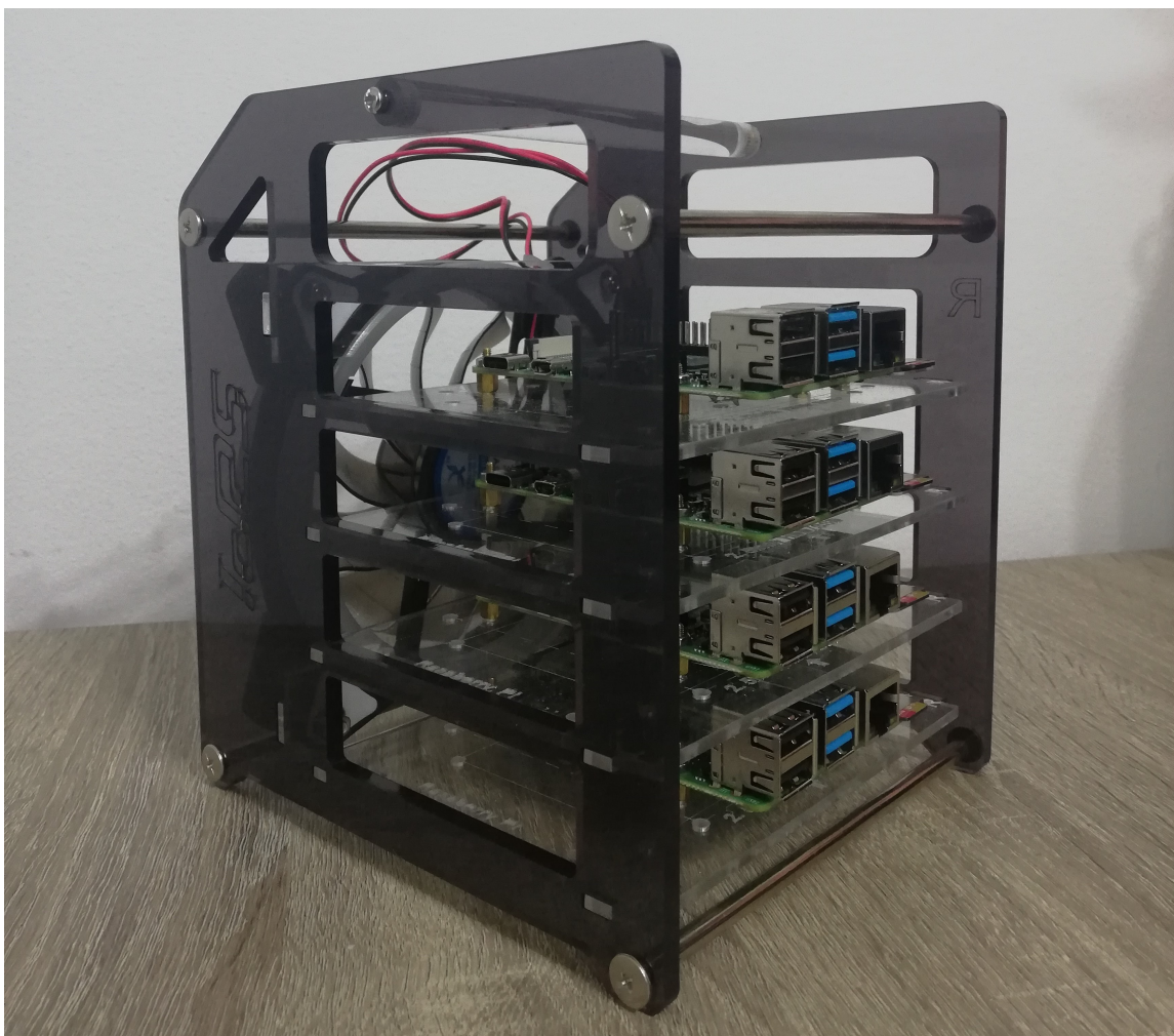
4. ábra. A kész négy csomópontos, hűtőberendezéssel ellátott Raspberry Pi klaszter
