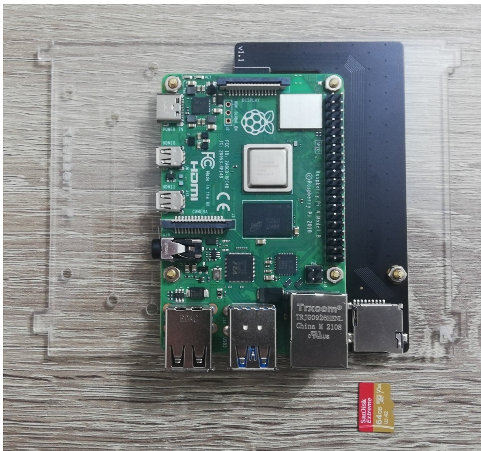
3. ábra. Az átlátszó lapra rögzített és csatlakozóval ellátott Raspberry Pi az SD kártyával.
