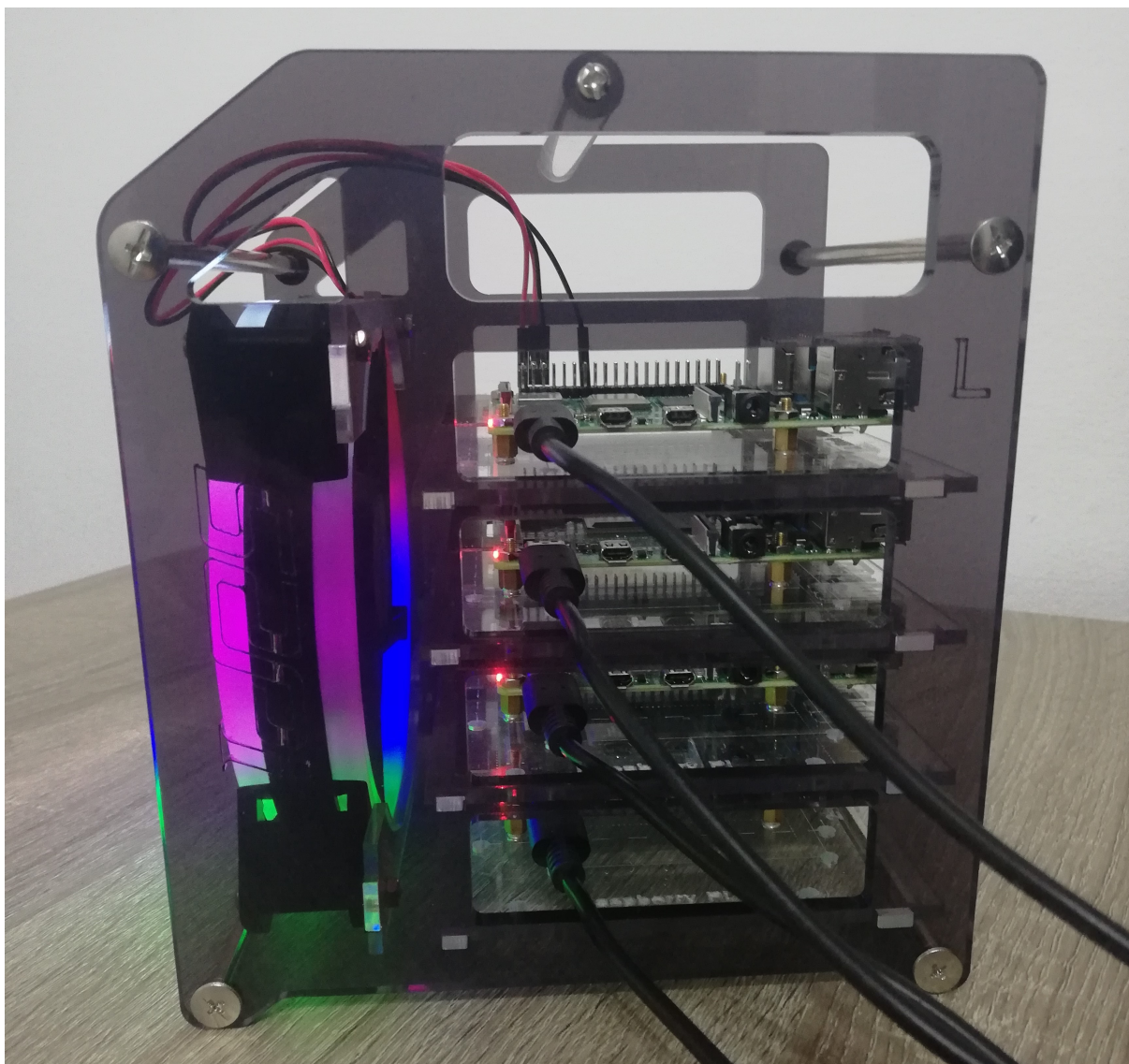
5. ábra. A kész négy csomópontos, hűtőberendezéssel ellátott Raspberry Pi klaszter
