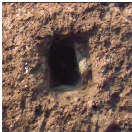
15a. ábra: Nyélfurat ólom nyomokkal
