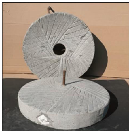
14. ábra: Az élezés, geometrikus mintája
