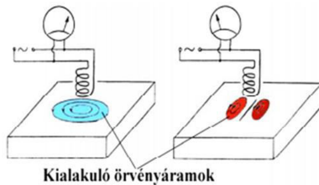
3. ábra: Az örvényáramos repedésvizsgálat elve [1]
