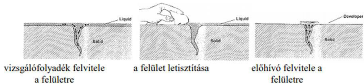
1. ábra: A folyadékbeholásos vizsgálat műveleti sorrendje [1]
