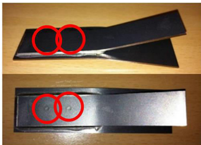
9. ábra: keményforrasztásos mintadarab
