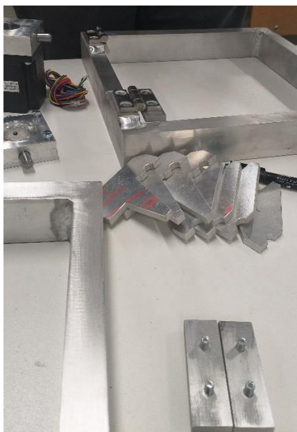
18. ábra: Keretek és a kivágott lemezek előkészítése hegesztésre
