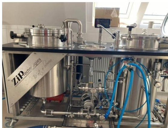
6. ábra: Ziptech Nano főző berendezés
