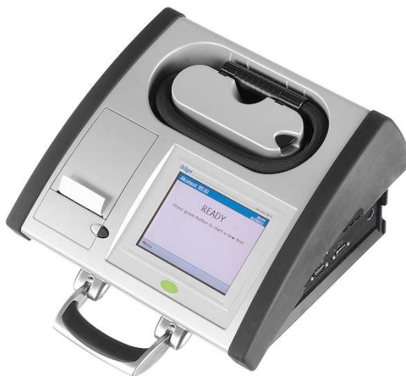
9. ábra: Dräger Alcotest 9510 típusú hiteles légalkoholmérő készülék forrás: https://www.draeger.com/Products/Media/Draeger-Alcotest-9510-01-D-43786-2015.jpg
