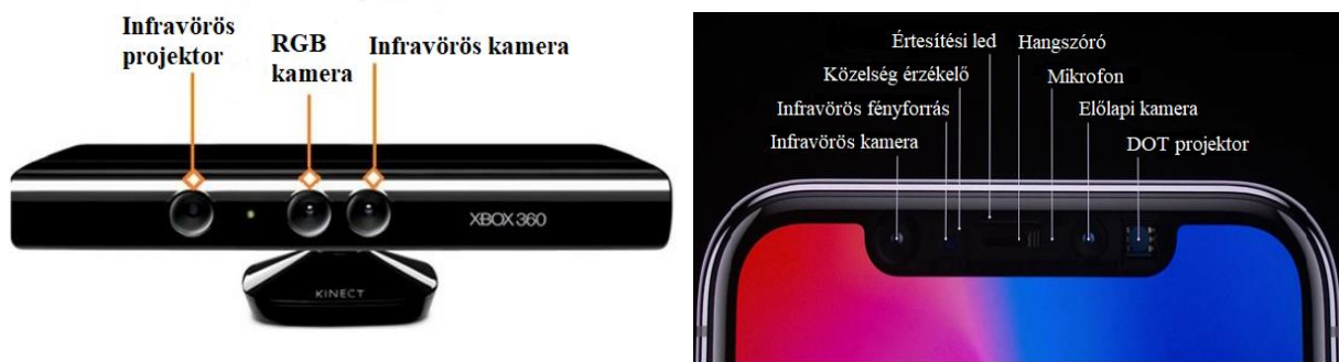
5. ábra: Az iPhone X lényegében egy Kinect. Megtalálhatóak rajtuk ugyanazon jellemzők.
