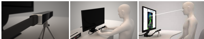
4. ábra: Az Eye Tribe szemmozgáskövető eszköze.
