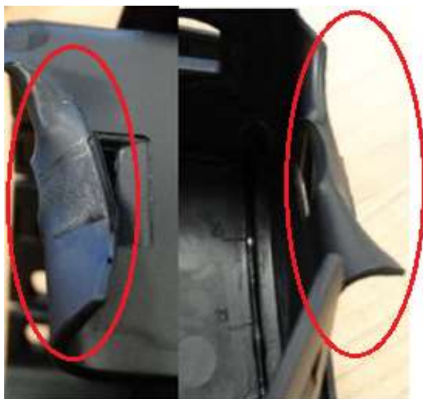
29. ábra Festés közben deformálódott termék
