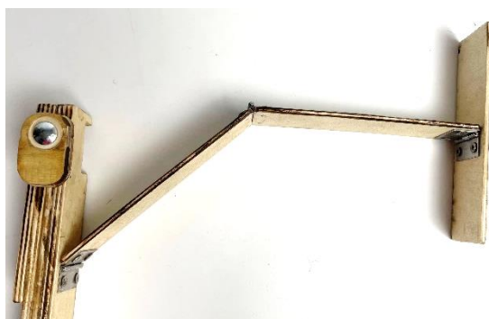
58. ábra. Zsanér túlfordulása (bal) és helyes kialakítás (jobb)
