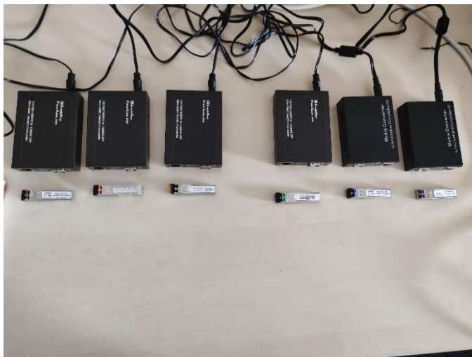
3.1 ábra: összes használt SFP és media converter. Az SFP-k a különálló alumínium borítású eszközök, a media converterek pedig a képen felettük látható fekete eszközök.
