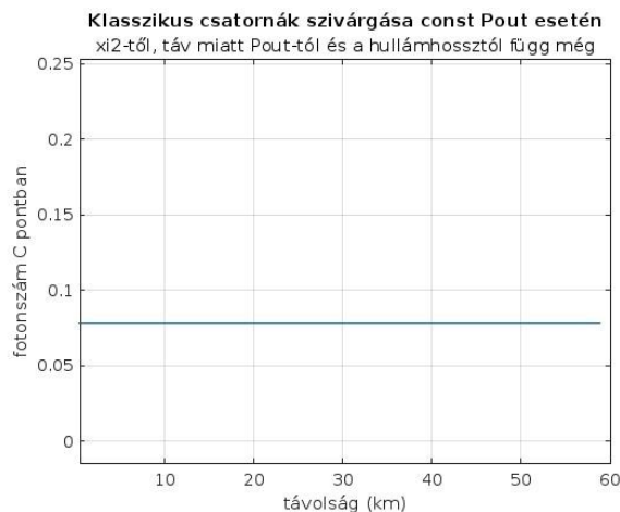
4.9 ábra: klasszikus csatornák szivárgása konstans kimeneti teljesítmény esetén a távolság függvényében
