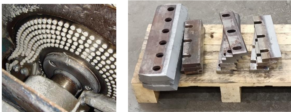
2.ábra. Granulátum levágása kétkéses szerszámmal (bal) [1], javításra váró kések (jobb) [18],
