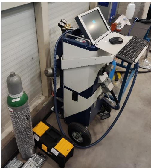
15.ábra. Az M340 szerszámacél vegyi összetétele spektroszkóppal mérve [18]
