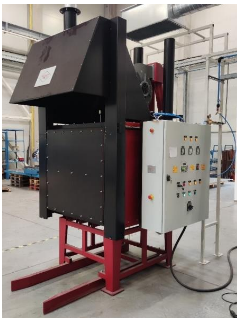
18.ábra. Muhel nitrogén védőgázas megersztő kemence [18]
