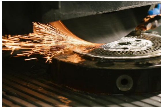
7.ábra. Granuláló fej (előlap) köszörülése [1]
