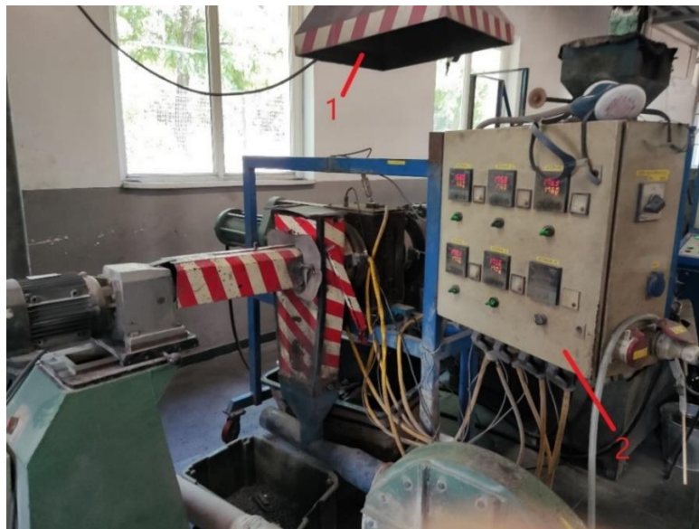
5.ábra. Gőzelvezetés (1) és hőmérsékletszabályozás (2) [18]
