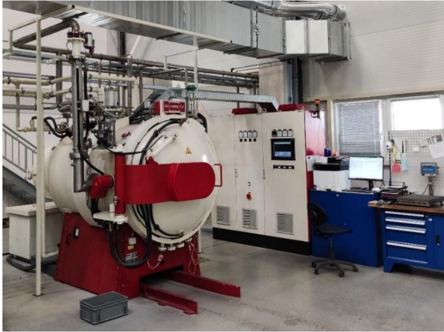
17.ábra. IU72/1F 2RV 60x60x40 10 bar CP Schmetz típusú vákuum kemence és szabályozó berendezése [18]
