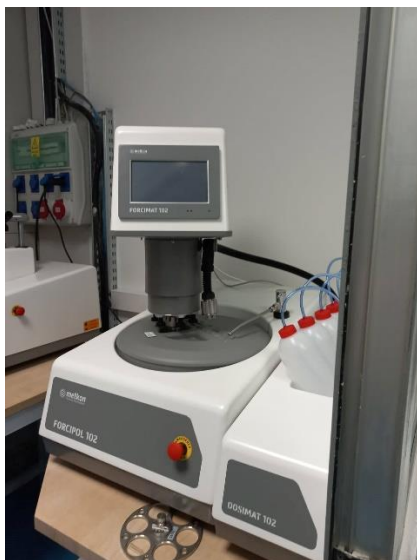
21.ábra. Csiszoló/polírozó gép (Metcon Forcipol 102) (bal), mikroszkóp (Olympus CKX53) (jobb) [18]
