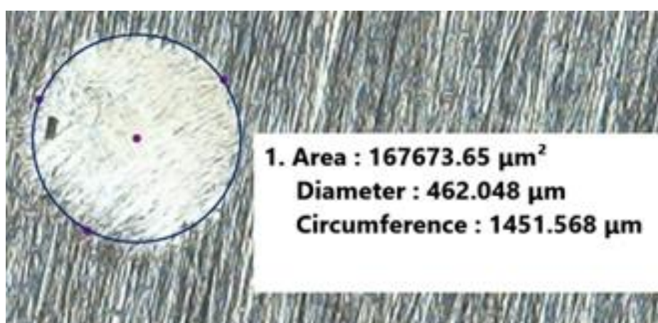
35.ábra. A harmadik minta 3. kopási képe [18]
