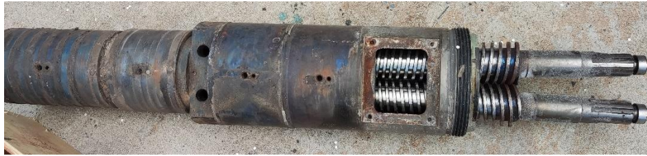
4.ábra. Kettős csigaház szellőzőfuratokkal [18]
