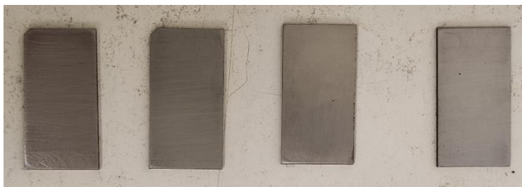
24.ábra. A koptatóvizsgálat próbatestei (jobb oldali kettő a mélyhűtött) [18]
