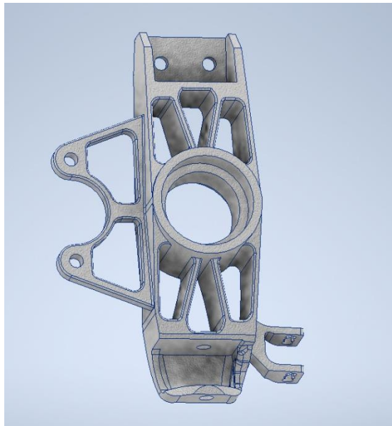
3. ábra: A csapat kikönnyített csonkállványa
