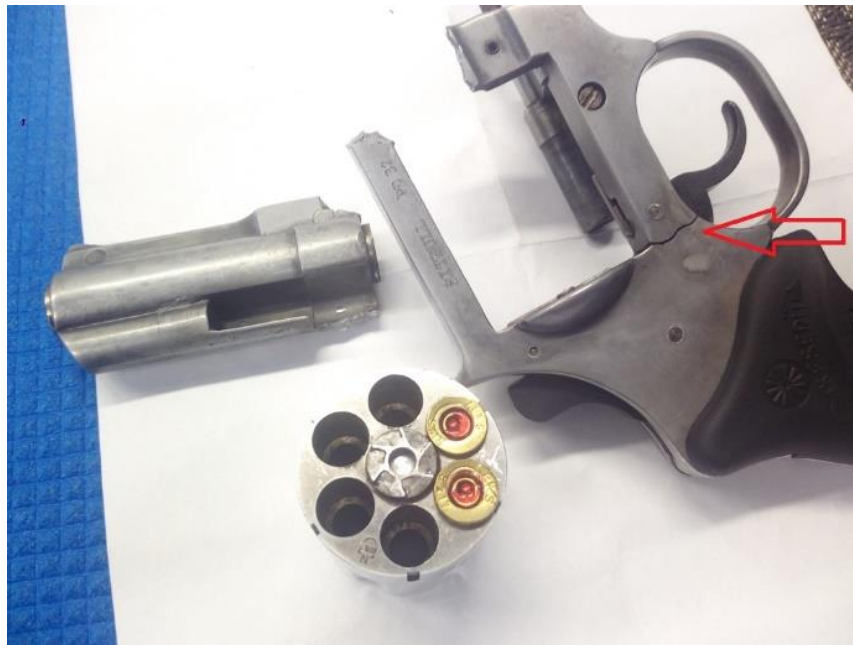
15. kép - Helytelen töltényhasználat miatt szétrobbant gázpisztoly [24]
