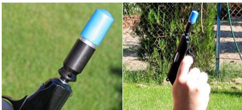
21. kép - Jelzőrakéta toldat rakétával [13]
