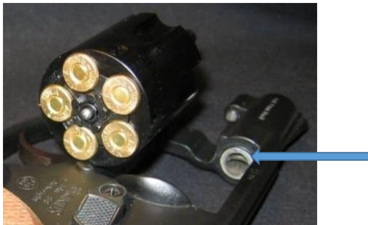
20. kép – Excentrikus csőfurat [10]
