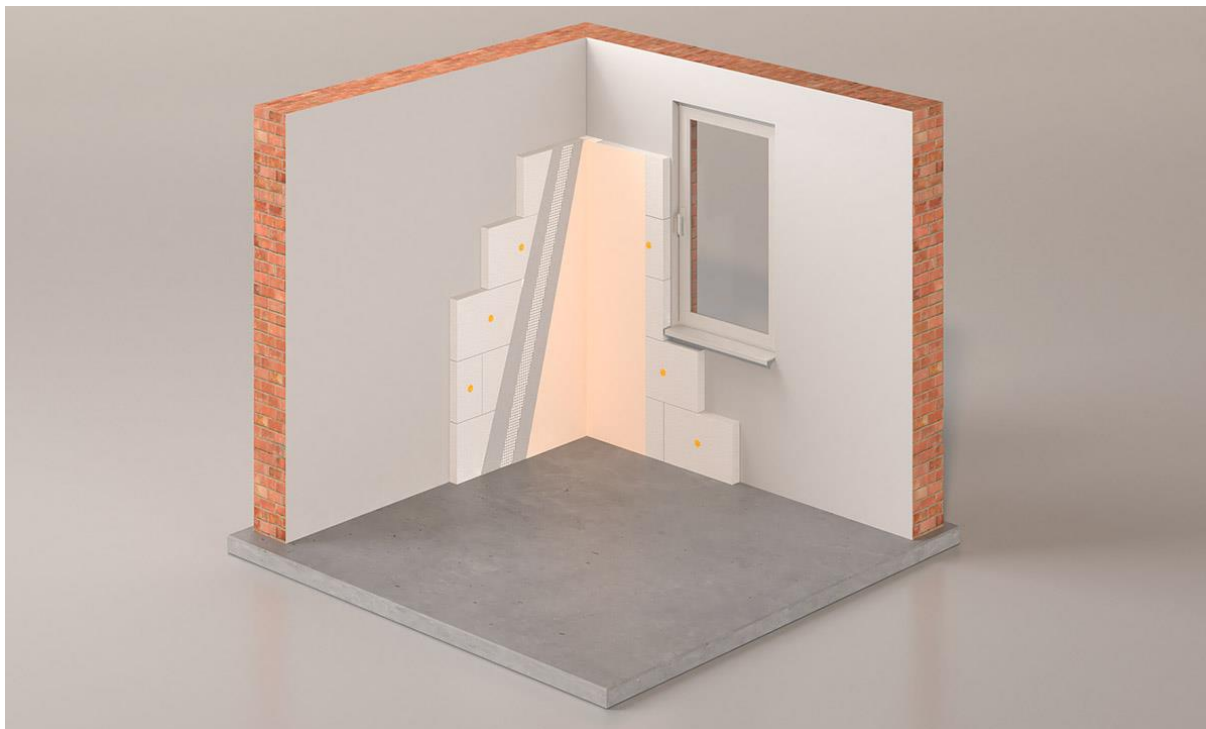
13. ábra: Xella Multipor hőszigetelő rendszer [43]
