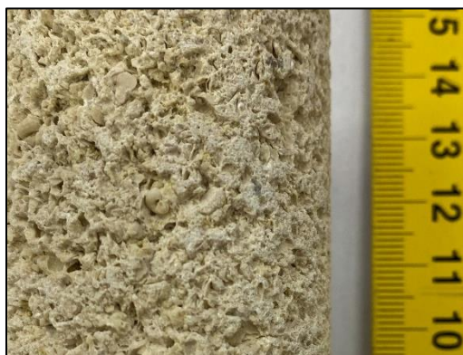
2.5 ábra. Durvább durva mészkő makroszkópos felvétele
