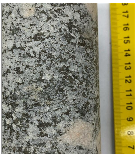
2.1. ábra. Gránit makroszkópos felvétele
