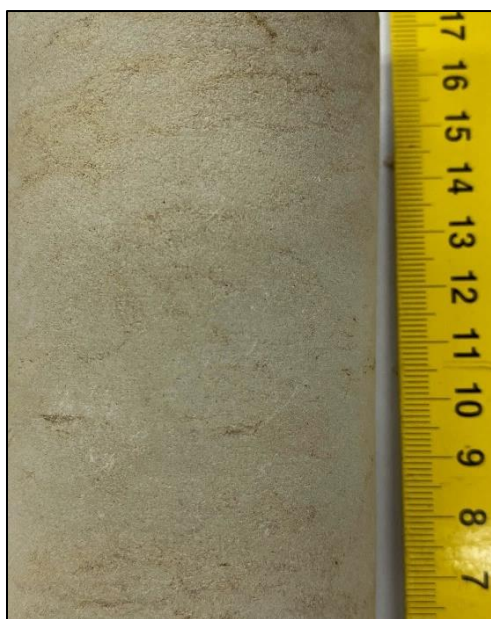
2.3 ábra. Márga makroszkópos felvétele
