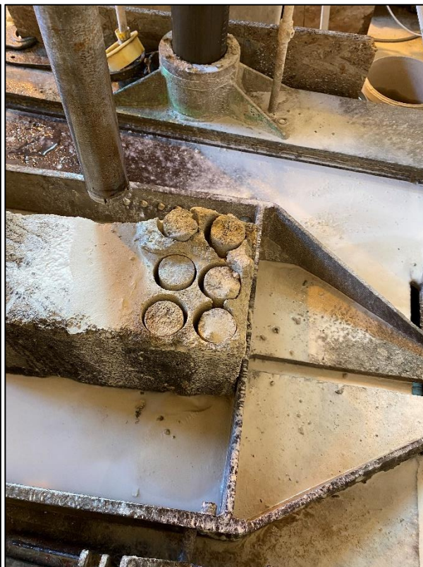
3.2 ábra. Gyémántkoronás fúróval kivágott hengerek a durva mészkő tömbből
