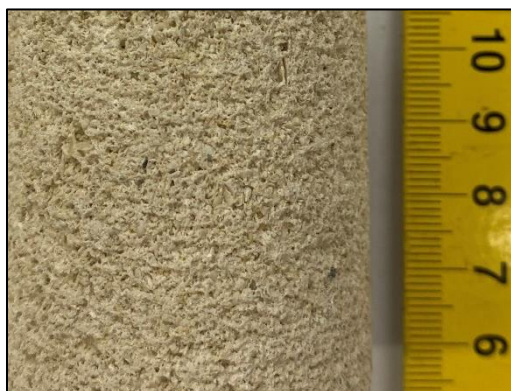
2.7 ábra. Finomabb durva mészkő makroszkópos felvétele
