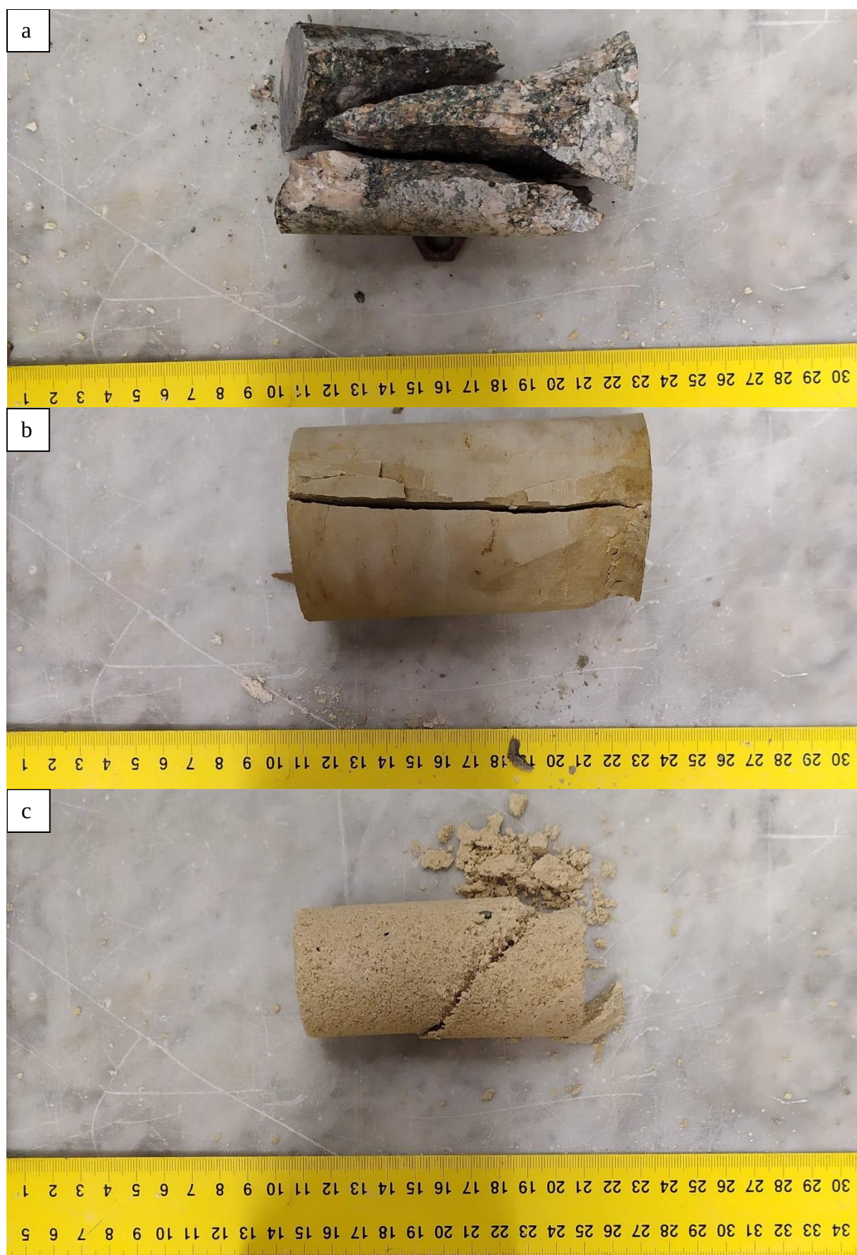
3.9 ábra. A a) 92-es gránit, b) 7-es márga, c) 15-ös durva mészkő próbatest törésképe
