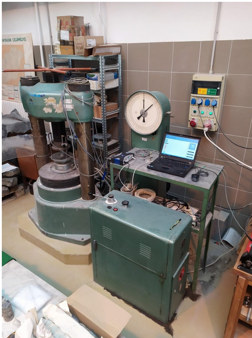
3.8 ábra. Egyirányú nyomószilárdság vizsgálat
