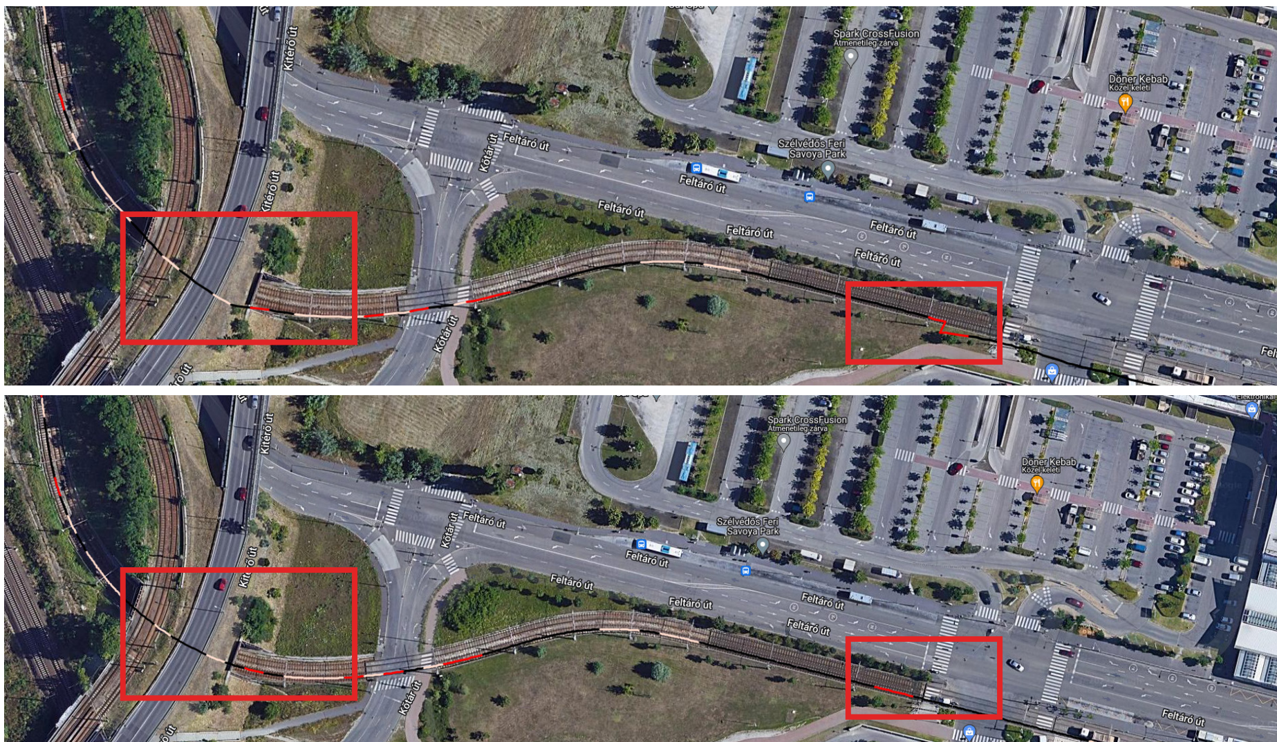
52. ábra – A mérővillamos GPS helyadatai alapján (felső kép), illetve a BInfra vágánytengelyen megjelenített (alsó kép) hibaadatok megjelenítése közötti eltérések
