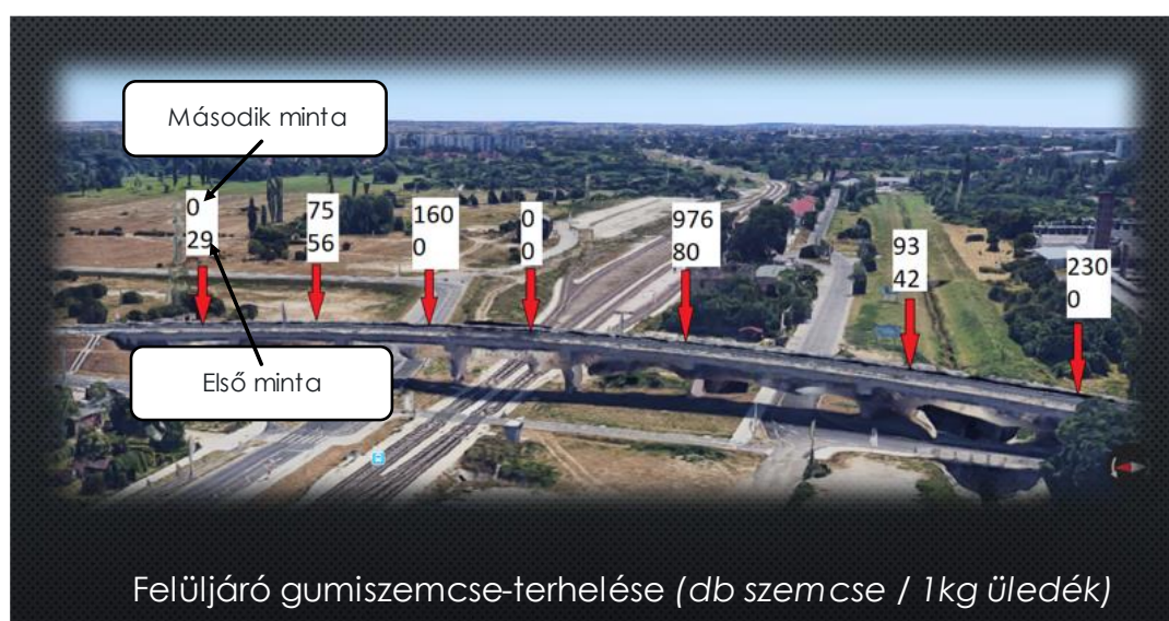
8. ábra Felüljáró gumiszemcse-terhelése (Urbán B. et al., 2021)
