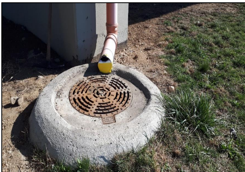
3. ábra Csővég mintázása átbukós feltétellel (Urbán B. et al., 2021)
