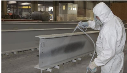
16. ábra: Korrózió elleni védőbevonat felvitele [23].
