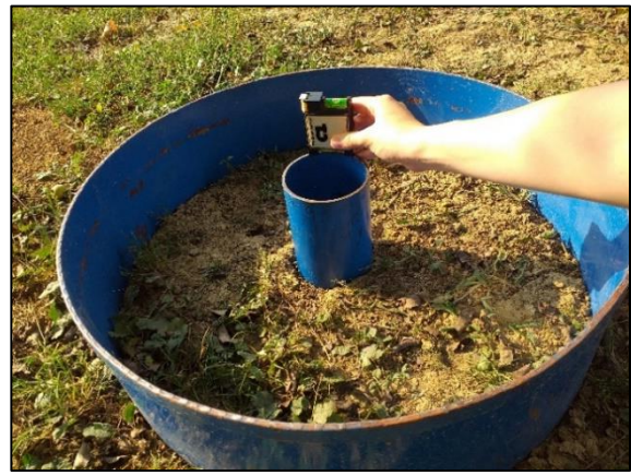
22. kép A belső gyűrű felső síkjának ellenőrzése
