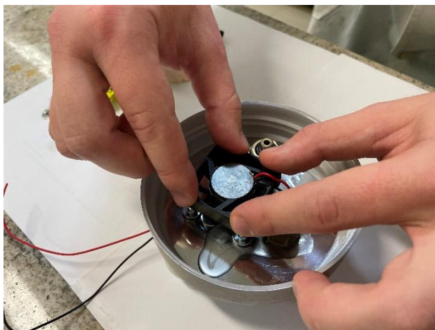
19. ábra A ventilátor ragasztása
