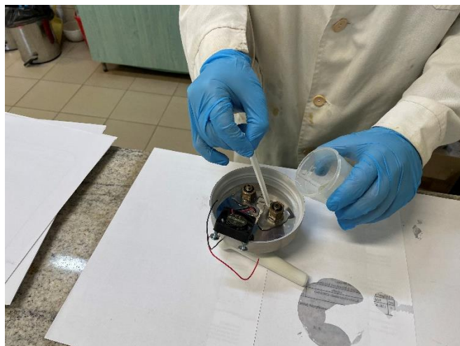
17. ábra A csapok ragasztása 1.
