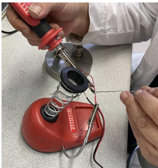
20. ábra A vezeték forrasztása
