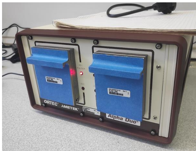
4.3. ábra: A kétkamrás Ortec Alpha Duo spektrométer
