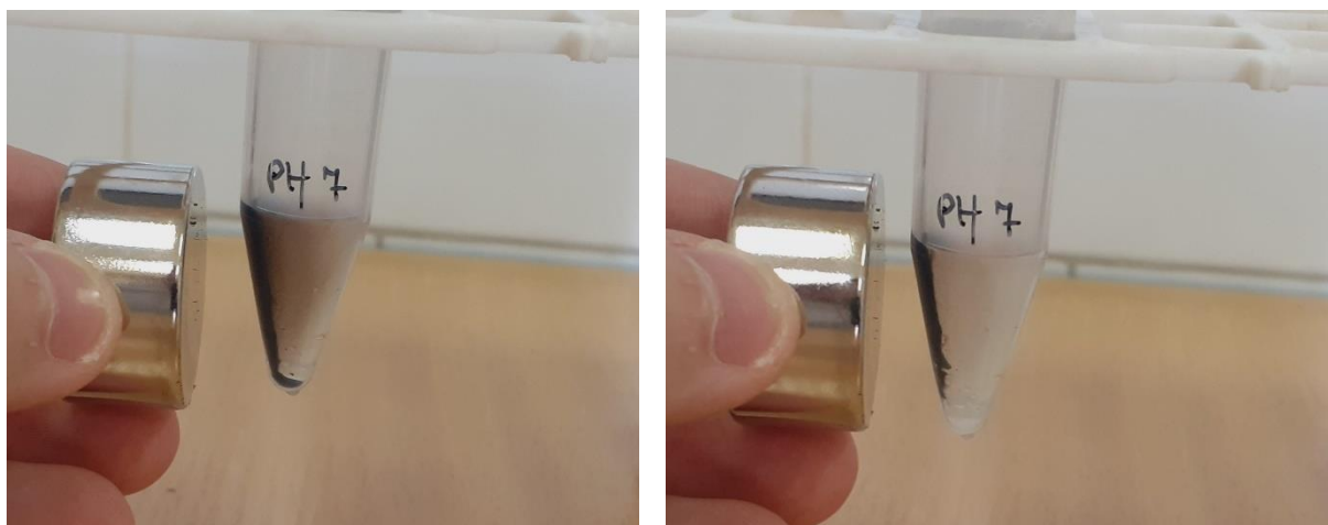
2-3. ábra: Kísérleti munkám során látható szuperparamágneses jelenség, amely során az oldatba vitt magnetit nanorészecskék mágnesezhetősége használható ki, mely előnyös tulajdonság lehet a víztisztítás során
