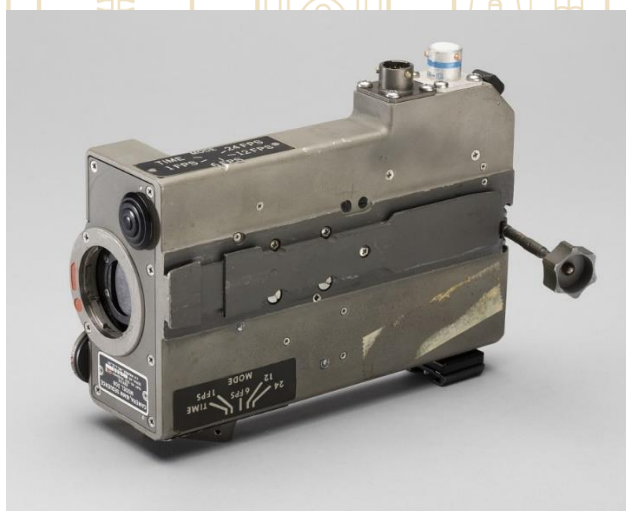
Maurer 16 mm-es adatgyűjtő kamera. [12] Kettő darab ilyen kamerát vittek fel az űrbe, az egyik a CSM míg a másik az LM modulban volt elhelyezve. 1,27 kg-ot nyom egy ilyen kamera.
