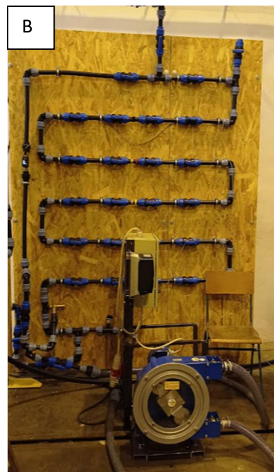
11. ábra: Ivóvízhálózat modell: A. Átfolyó üzemű egység (fal), B. Keringetett üzemű egység (fal)
