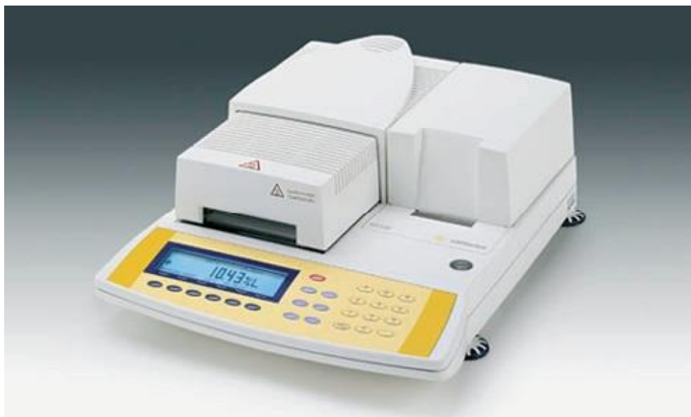
5. ábra Sartorius automata nedvességmérő (Sartorius MA50/MA100 Series Moisture Analyzer - Dynamic Scales, Inc. - Scale & Measurement Specialist, é. n.)
