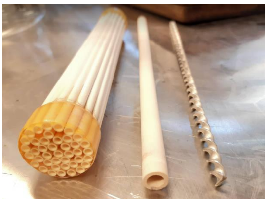
8. ábra Membránok: kapilláriskapillár membrán (bal), csőmembrán (közép), statikus keverő (jobb)
