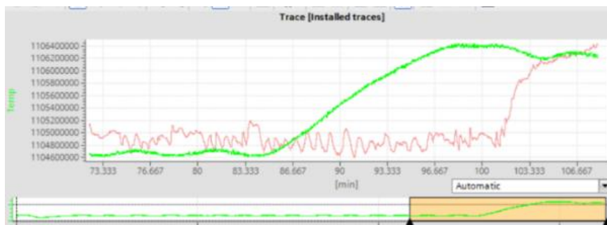
23. ábra: Klímakamra szabályozás diagramja 30°C-on 60 % relatív páratartalom mellett 3.
