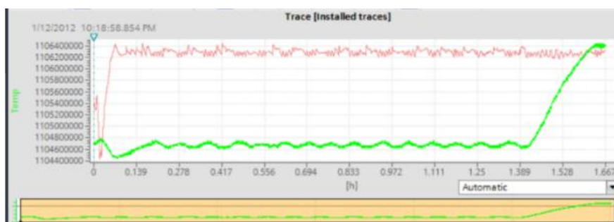
24. ábra: Klímakamra szabályozás diagramja 30°C-on 60% relatív páratartalom mellett 4.
