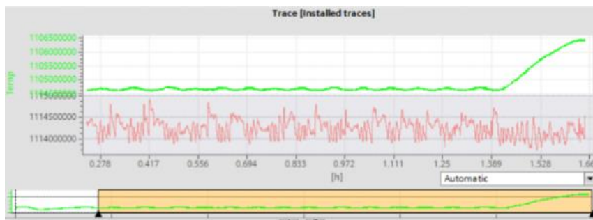
22. ábra: Klímakamra szabályozás diagramja 26°C-on 30 % relatív páratartalom mellett 2.
