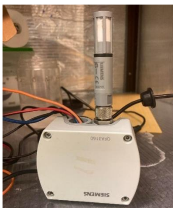
13. ábra: Siemens QFA3160 hőmérséklet és páratartalom szenzor
