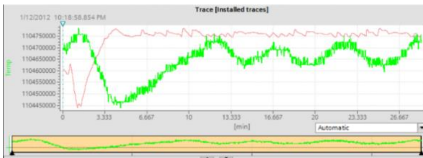
21. ábra: Klímakamra szabályozás diagramja 26°C-on 30 % relatív páratartalom mellett 1.
