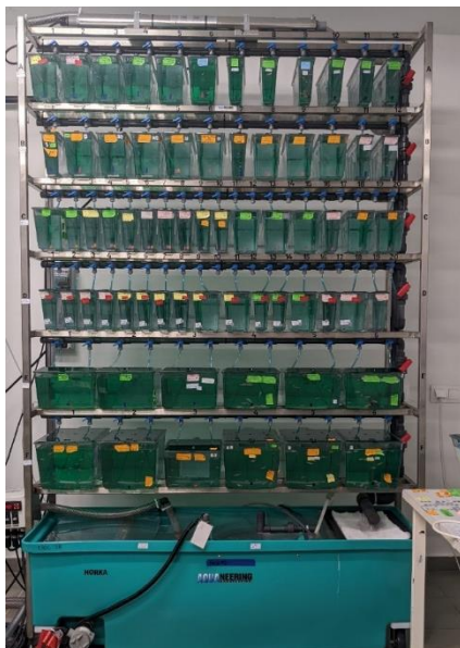
4.ábra: A zebradániók tartására használt rendszer. A rendszer alján lévő tartályban a víz egy többlépcsős szűréseken keresztül tisztul meg, majd UV fertőtleníti. Két ilyen rendszer található a szobában. A tartályok a rendszeren különböző méretűek, a halak létszámának és méretének megfelelően. (Forrás: Saját kép)
