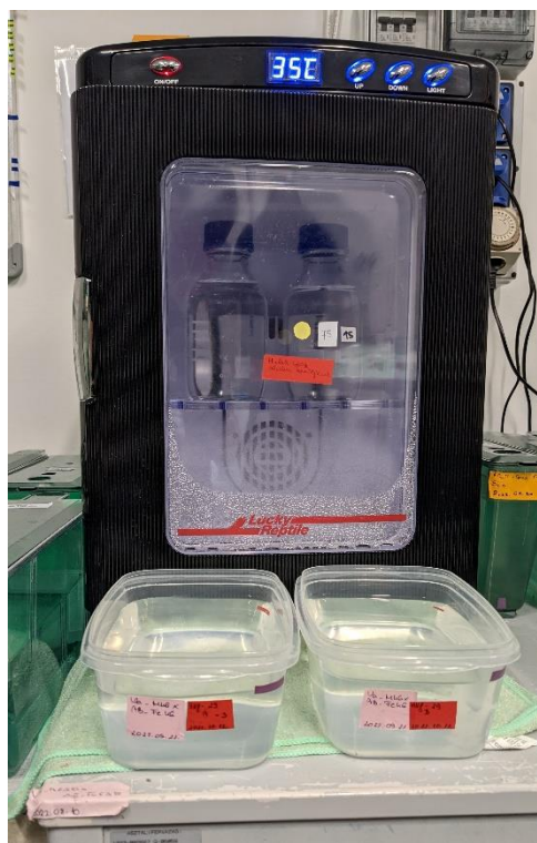
9. ábra: A krónikus hőkezeléshez használt inkubátor. Az inkubátorban a folyamatos 14 napos kezelést végeztük, amely során kb. 35-36 °C-on tartottuk a halakat (Forrás: Saját kép).
