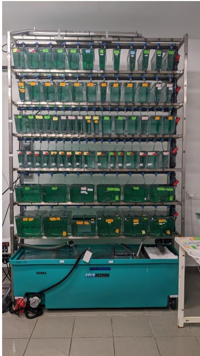
10. ábra: A haltartó rendszer. A moduláris haltartó rendszer polcain különböző térfogatú tartályokat tudtunk elhelyezni. A recirkulációs elven működő rendszer a saját vizét keringette, a víz eközben több tisztítási lépésen átesett, mire visszajutott a tankokba.
