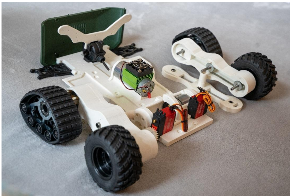
8.2. ábra - Terepjáró speciális járószerkezetének gyártott alkatrészei
