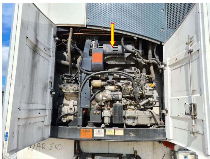
4.3. ábra Thermo King hűtőrendszer, és a beépített SLX motorház
