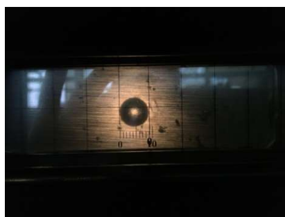
5.6. ábra Brinell-keménységmérés lenyomata
