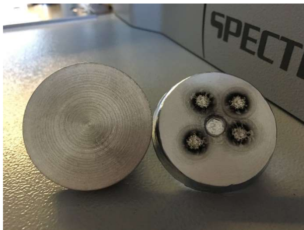
5.3. ábra Aszinképelemzés próbatestei vizsgálat előtt és után
