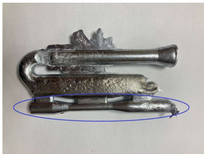
5.8. ábra A próbatest öntvénye a beömlőrendszerrel
