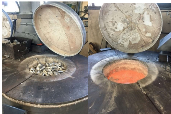
3.6. ábra Alumínium olvasztása gázüzemű olvasztótégelyben
