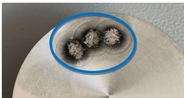
5.12. ábra Aszínképelemzés próbatestei vizsgálat előtt és után
