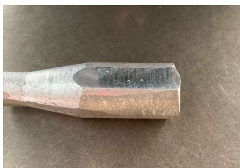
5.14. ábra Brinell-keménységmérés lenyomatai
