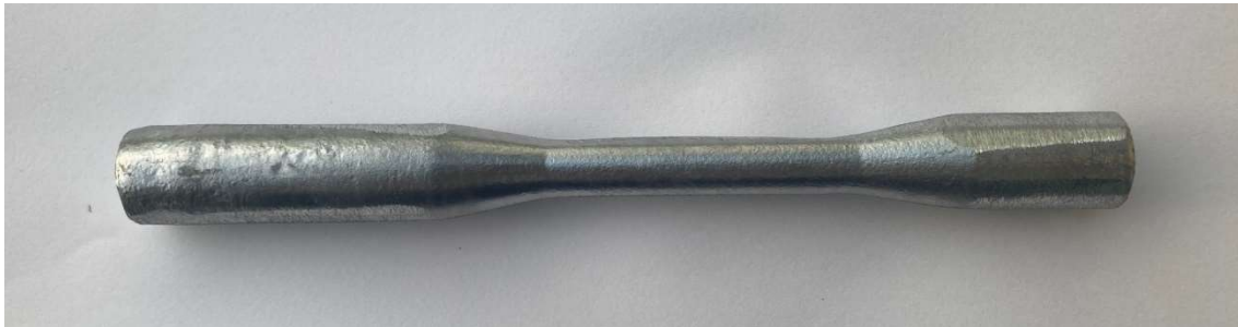
5.9. ábra Az EN-AC 44100 próbatest, a szakítóvizsgálatra előkészítve
