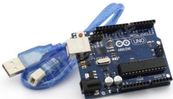
27. Ábra: Arduino Uno R3 Forrás: www.hestore.hu
