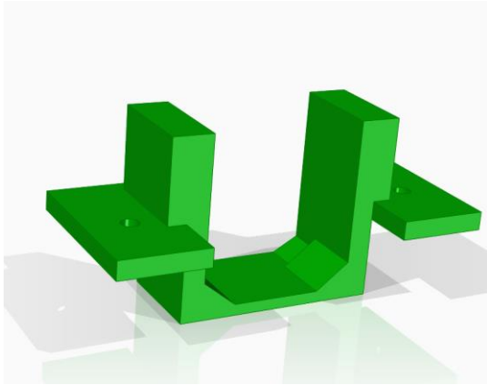
5. Ábra: A motortartó 3 dimenziós ábrázolása. Forrás: saját kép
