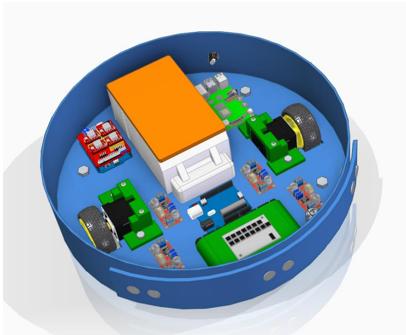
13. Ábra: A robotporszívó összeállított ábrázolása (tető elem nélkül) 3 dimenziós ábrázolásban.
