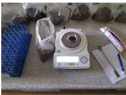
6. ábra: A talajminták kimérése a kémcsövekbe. (Fotó: Selmeczi Dóra, 2021.10.25., Gödöllő)
