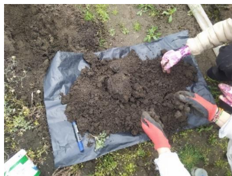
5. ábra: Földigilisztá mintavételi gödör ásása és a kiemelt talaj kézi átmorzsolása
