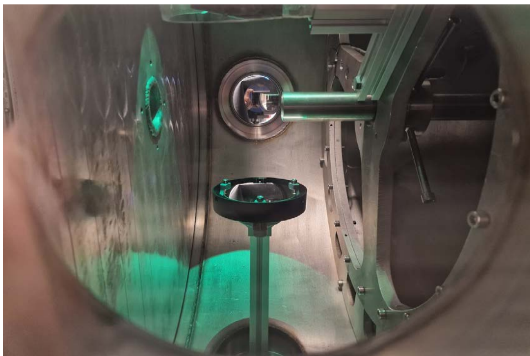
10. ábra. A vákuumkamrába behelyezett tükör. A pellet a bal oldali nyílásból érkezik, és a jobb oldali csövön halad tovább.
