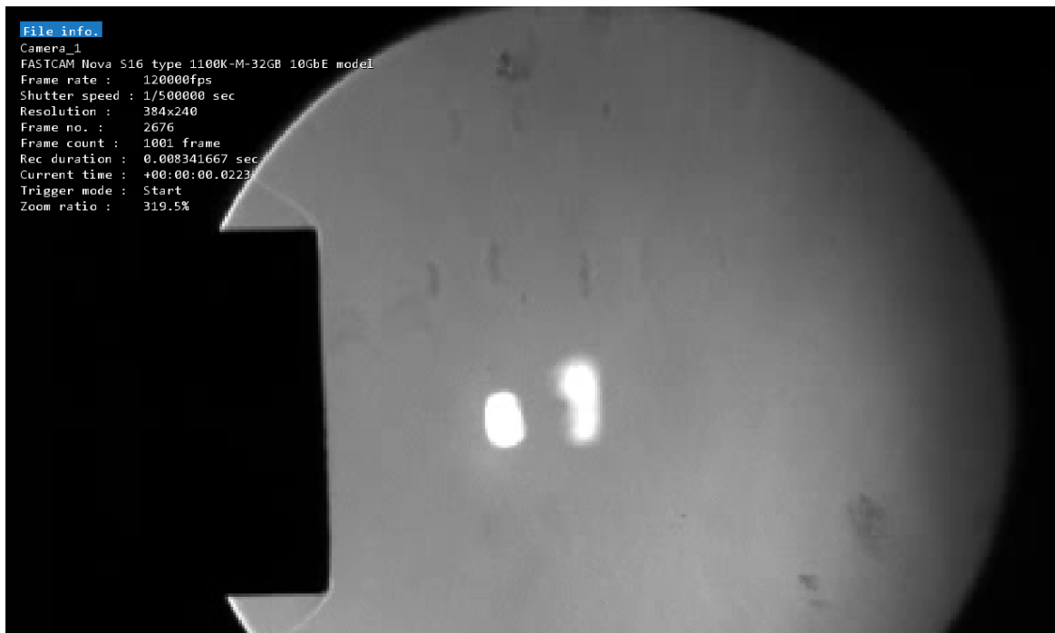
18. ábra. #64; 800 V-os szelep nyitási feszültség. Láthatóak a cső mentén kialakuló lökeshullámok (bal oldalt)
