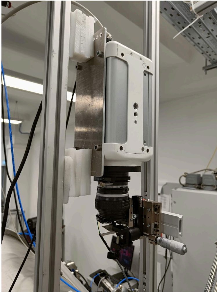
12. ábra. A gyorskameránk, illetve a LED és a kitakarás, felhelyezve a vákuumkamra fölé
