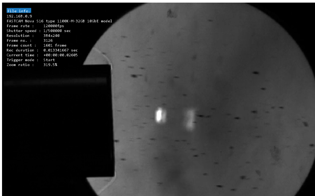
23. ábra Apró pellet darabok a Schlieren-képen, és a jól látható torok-lökéshullám
