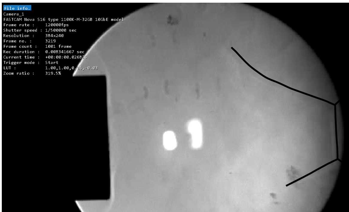
19. ábra. #64; 800 V-os szelep nyitási feszültség. Láthatóak a cső mentén kialakuló lökeshullámok és Mach-gyámánt képződmények (feketével kiemelve)
