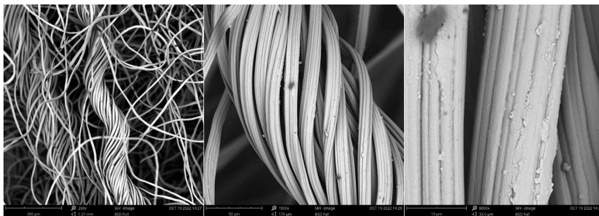
Pamut szálak vatta mikroszkóp alatt, egyre nagyobb nagyításban – látható a barázdált felület
