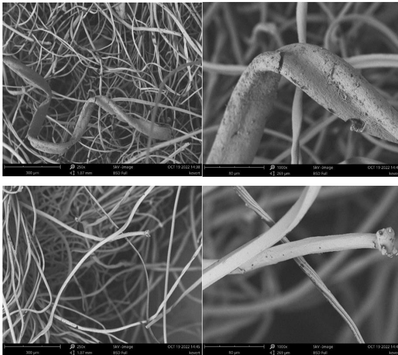
Kevert szálak vatta mikroszkóp alatt, jobb oldalt nagyobb nagyításban
