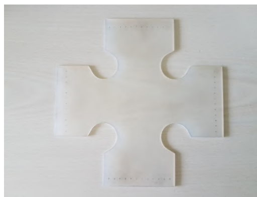
(b) Egy kéttengelyű kivágott próbatest.
