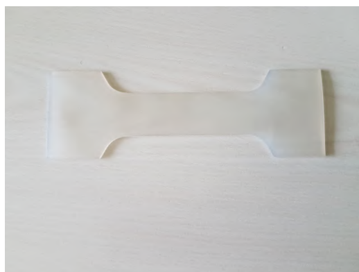
(a) Egy egytengelyű kivágott próbatest.
