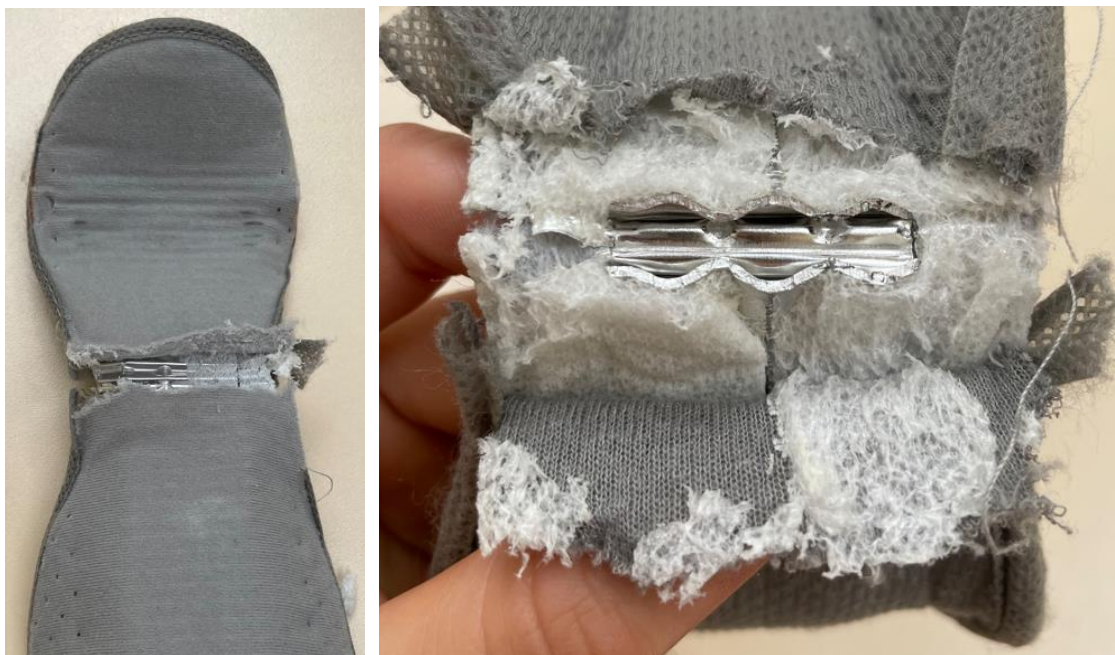
5.5. ábra A fűrésztett eszköz törésének helye és a töretfelület kinézete kibontás után
