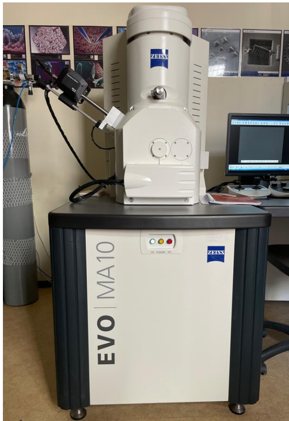
5.15. ábra. A ZEISS EVO MA10 pásztázó elektronmikroszkóp (BME ATT)
