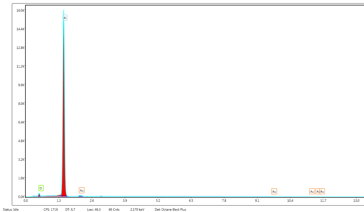
5.20. ábra. A tapadási hézagban lévő forgácsdarabok egyikének EDS-spektruma
