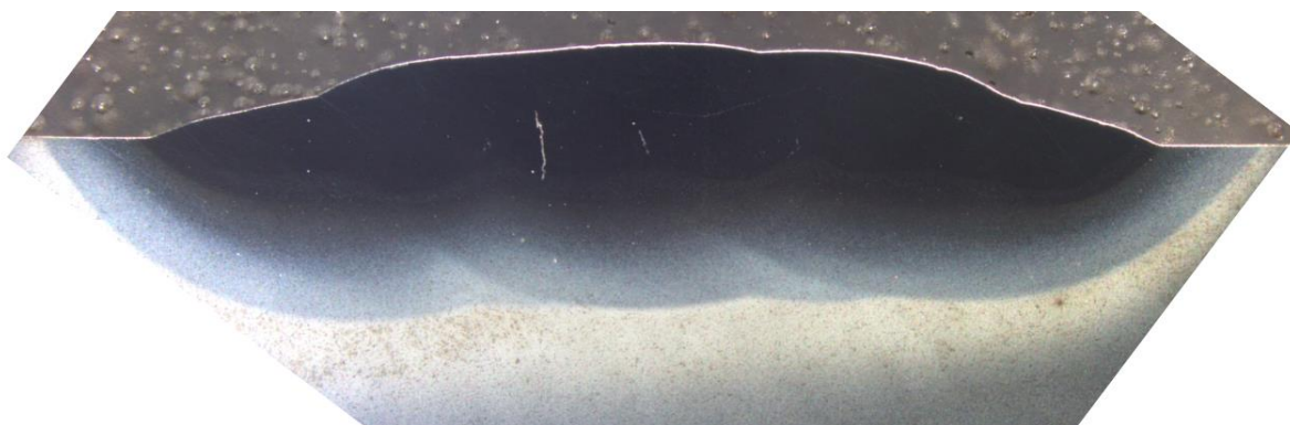
12. ábra: Sztereomikroszkóppal készült felvétel az 9. jelű varratsorról.
