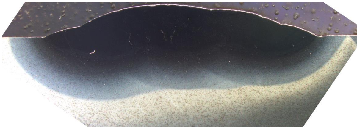
9. ábra: Sztereomikroszkóppal készült felvétel az 6. jelű varratsorról.
