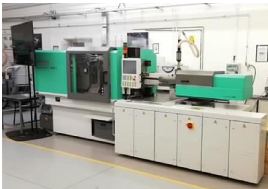
17. ábra Arburg Allrounder 470 A 1000-290-es fröccsöntőgép [21]
