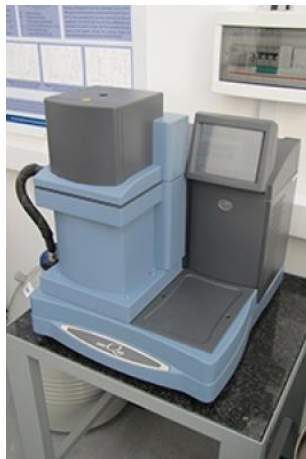
20. ábra: DMA berendezés [23]
