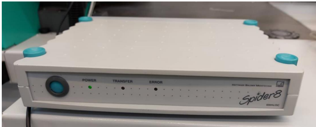
22. ábra Spiders 6000/DC típusú adatrögzítő egység
