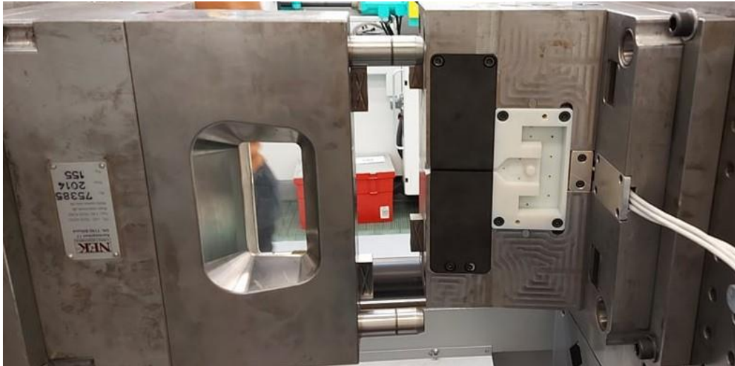
18. ábra Üvegbetétes fröccsöntőszerszám
