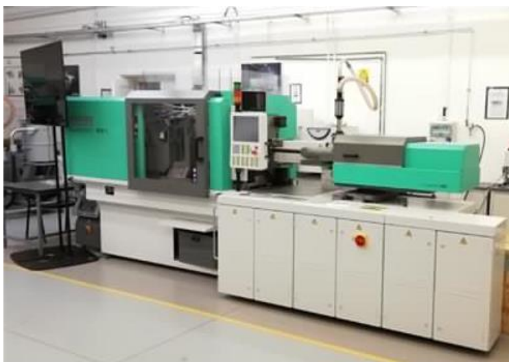
14. ábra Arburg Allrounder 470 A 1000-290-es fröccsöntőgép [18].
