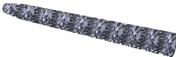
3. ábra: Az ömledék áramlását módosító 3D nyomtatott alkatrész
