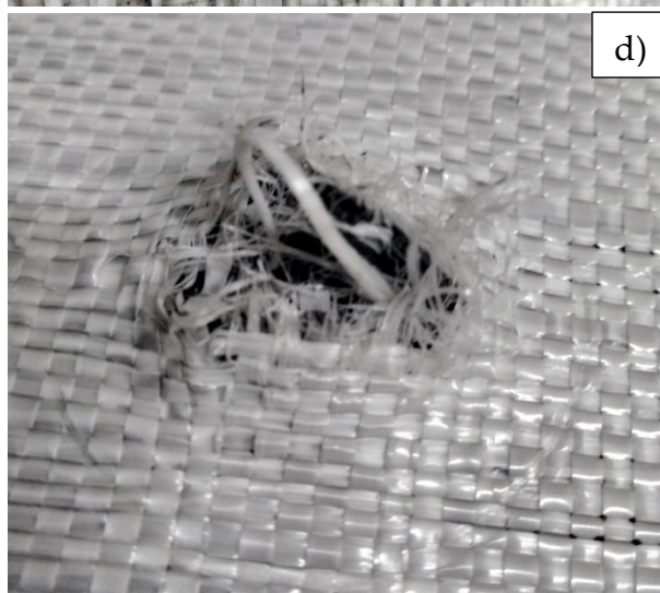
20. ábra: A kompozitokra jellemző tönkremeneteli módok (a) SPC_APAO, b) SPC_APAO/CNT, c) SPC_TPE, d) SPC_TPE/CNT)
