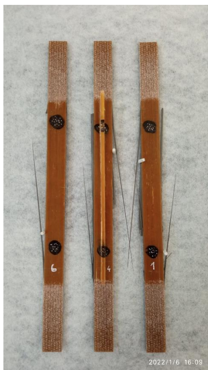
21. ábra: Párhuzamos repedések szemléltetése a vizsgálat után (Co-cured 0 sorozat)
