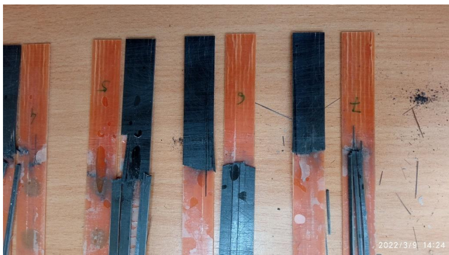
31. ábra: A Bonded 2 sorozat szétnyitott próbatestei a ragasztóban található légbuborékokkal
