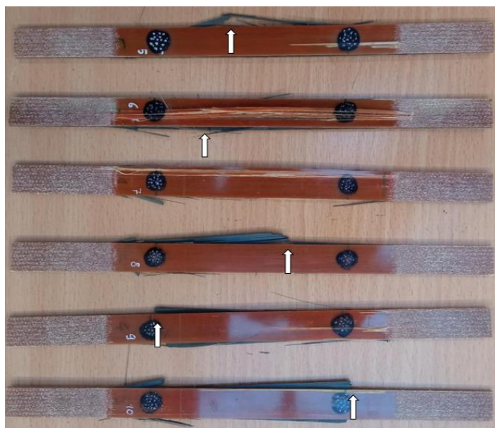
23. ábra: A Co-cured 1 sorozat próbatestei szakítóvizsgálat után (a jelölések tönkremenetek helyét mutatják)
