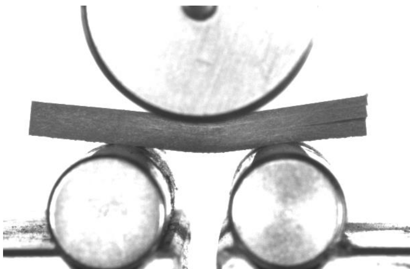
21. ábra Egy jellegzetes, több felületen jelentkező rétegelválásról DIC berendezéssel készített felvétel
