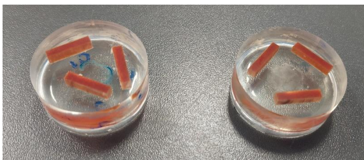
10. ábra A mikroszkópos vizsgálat beágyazott, polírozott mintái
