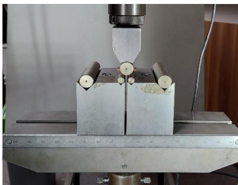
9. ábra A rövid támaszközű hárompontos hajlítóvizsgálat mérési elrendezése
