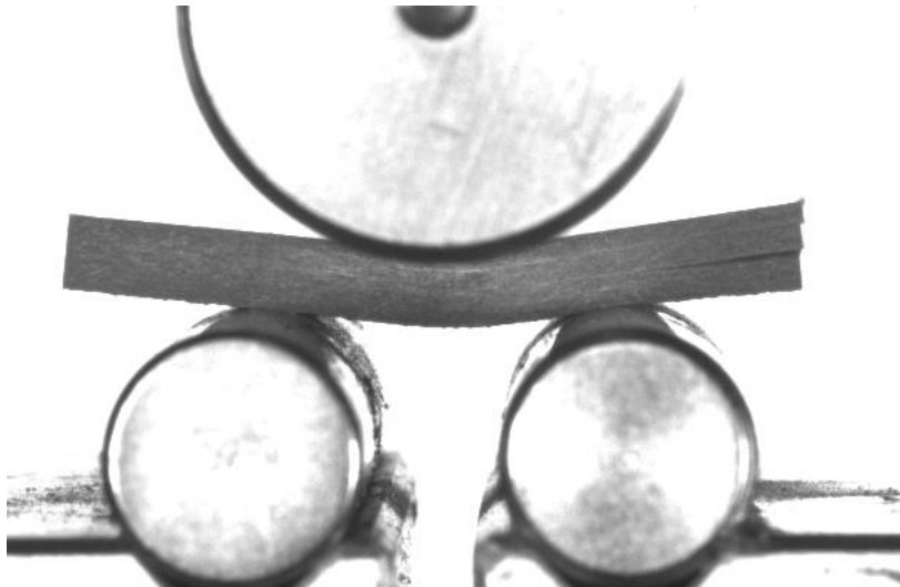
34. ábra Egy jellegzetes, több felületen jelentkező rétegelválásról DIC berendezéssel készített felvétel
