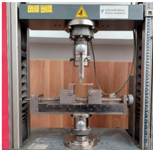
15. ábra A hárompontos hajlítóvizsgálat mérési elrendezése
